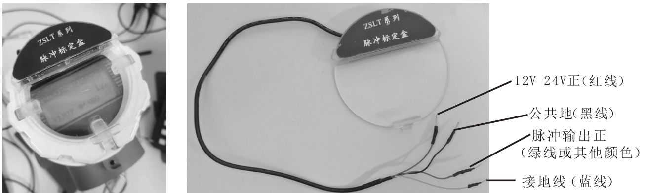
检定状态脉冲输出接线图
